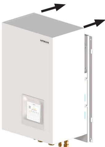
2 Placez les orifices du côté droit du panneau de l'unité intérieure sur les charnières de la plaque arrière (deux emplacements). Lorsque le côté droit est centré, répétez l'opération pour le côté gauche. Placez les orifices du côté gauche du panneau de l'unité intérieure sur les charnières de la plaque arrière (deux emplacements).
