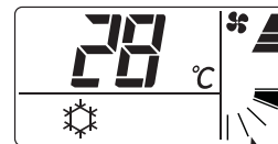
A hűtési művelet terelőlap szöge 1 lépésre, „High”-ra van beállítva.
