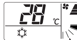
Úhel lamely je v chladicím režimu při „High“ nastaven do 1. polohy.
