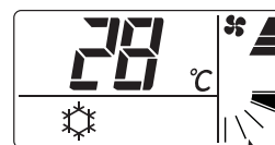
O ângulo do defletor está ajustado para “High” (posição 1) no funcionamento do arrefecimento.
