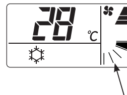
In de stand "High" van de koelmodus staan de lamellen in stand 1.
