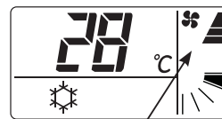
Fläkthastigheten ställs på "High" under kylning.
