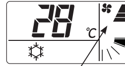
A hűtési művelet ventilátor sebessége „High”-ra van beállítva.
