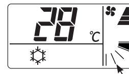
Der Luftklappenwinkel ist auf Position 1 bei „High“ im Kühlbetrieb.
