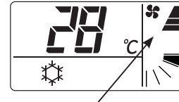
Die Lüfterdrehzahl ist auf „High“ im Kühlbetrieb eingestellt.
