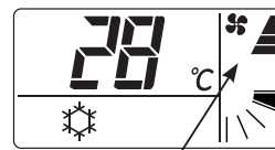
Dzesēšanas darbības režīmā ventilatora ātrums ir iestatīts uz “High”.
