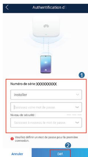
**Étape 4** Définissez les paramètres du routeur et du système de gestion pour mettre en œuvre la gestion à distance.
